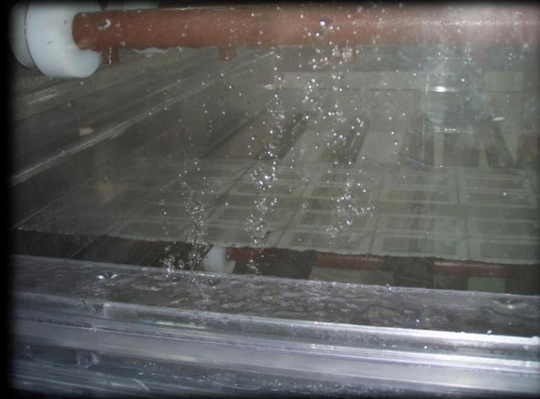
アルミニウム箔積層フィルムのエッチング
