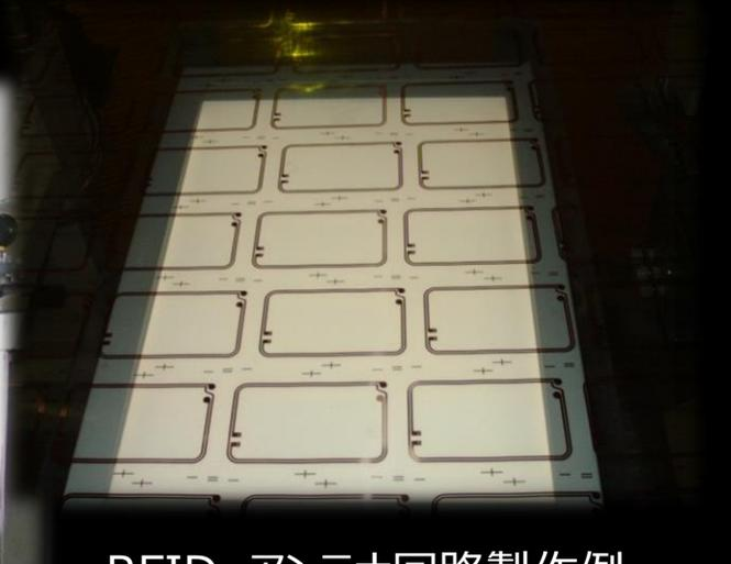
RFID アンテナ回路製作例
