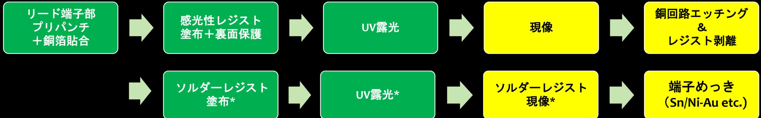
\* ソルダー印刷法の場合には露光・現像工程不要。端子鍍金を先に施す場合もある。
