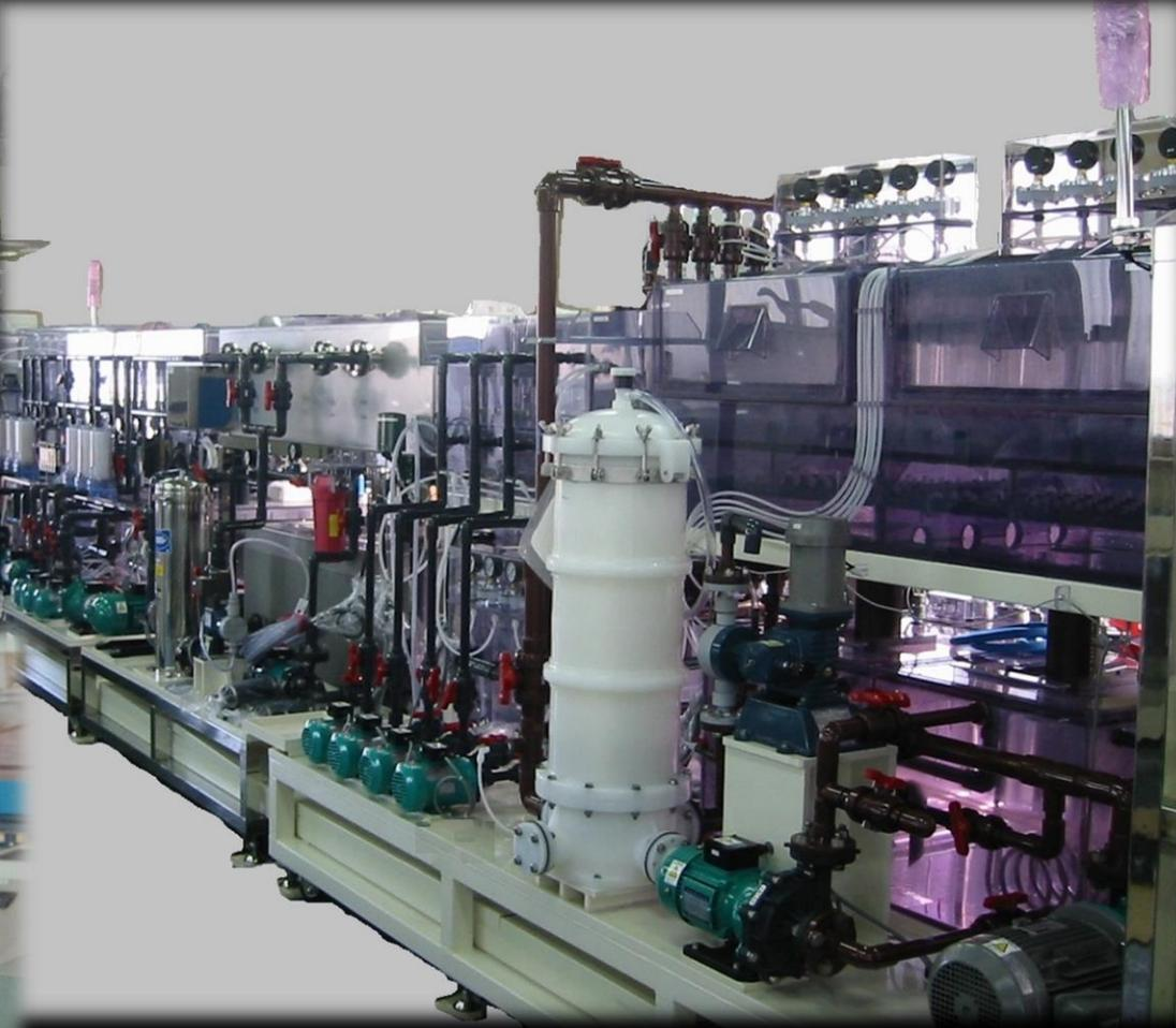
RTR FPC用 エッチング剥離装置(250W)
