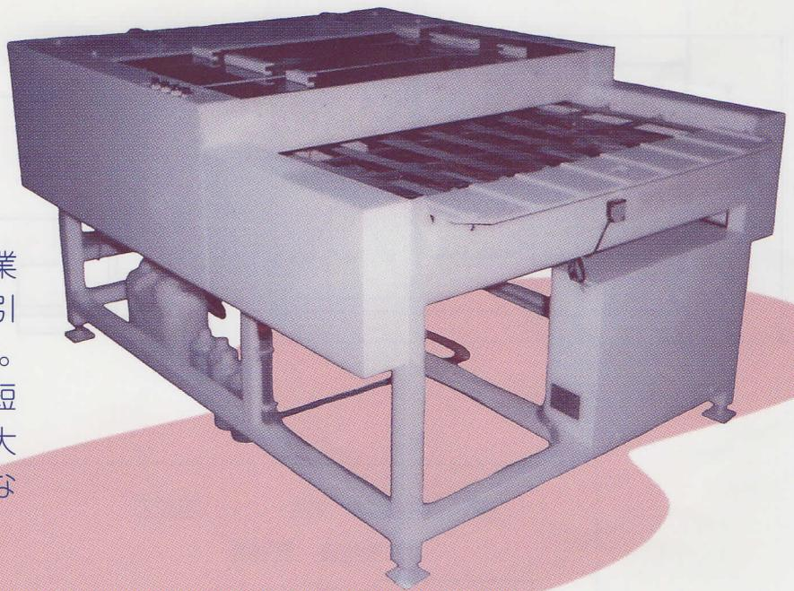
※ <SPW-B>は、PS版の消去作業後の水洗洗浄と仕上げゴム引工程を一体化した装置です。従来作業に比べ処理時間が短縮され刷版工程の作業性が大きく向上されると同時に大幅なコストダウンが出来ます。
