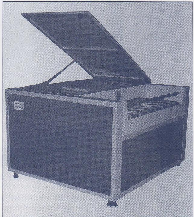
ガム固着トラブルがあるため、新たにインターバルタイマーを採用。ガムポンプ、ローラーを稼動時以外も間欠運転させガムコーターの乾燥を防止。
